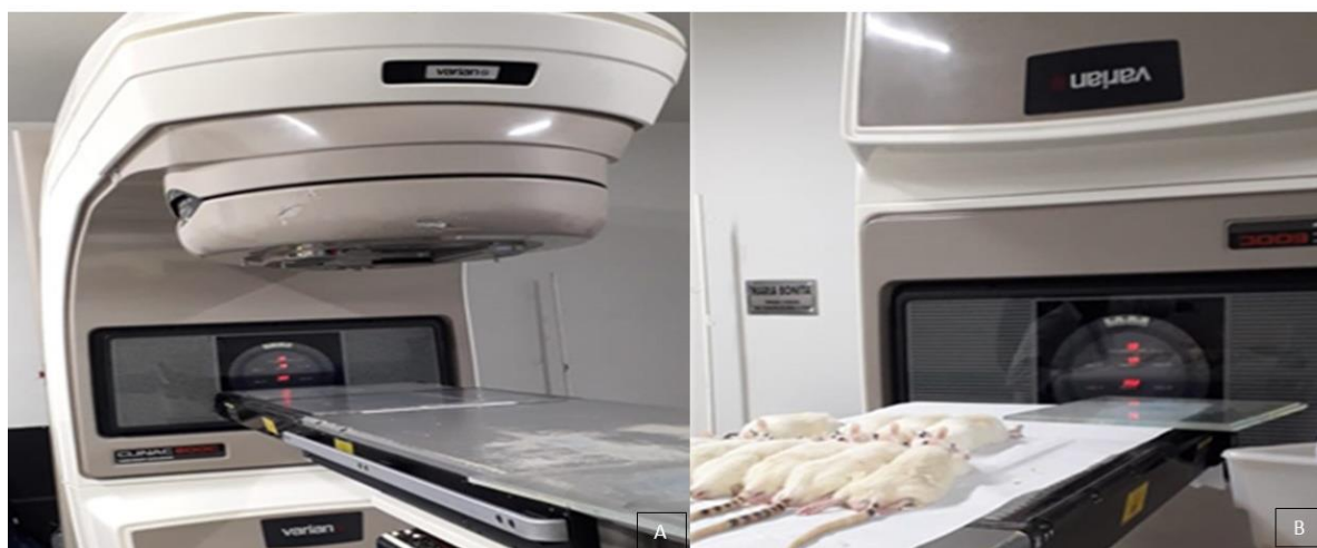
FIGURA 10. Acelerador linear Varian, modelo Clinac 600C (A), com os animais anestesiados e posicionados em decúbito dorso-ventral para irradiação da região de cabeça e pescoço (B). (Fonte: arquivo pessoal).
