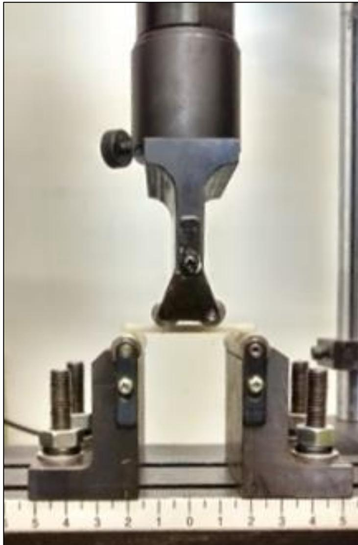
Fonte: Autor, 2016. Imagem da maquina universal de ensaios, mostrando o ensaio de flexão.
