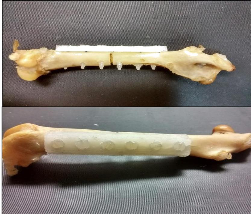
Fonte: Autor, 2016. Placas com seis furos e parafusos bloqueados em PLA, em um fêmur de coelho simulando uma futura aplicação experimental.
