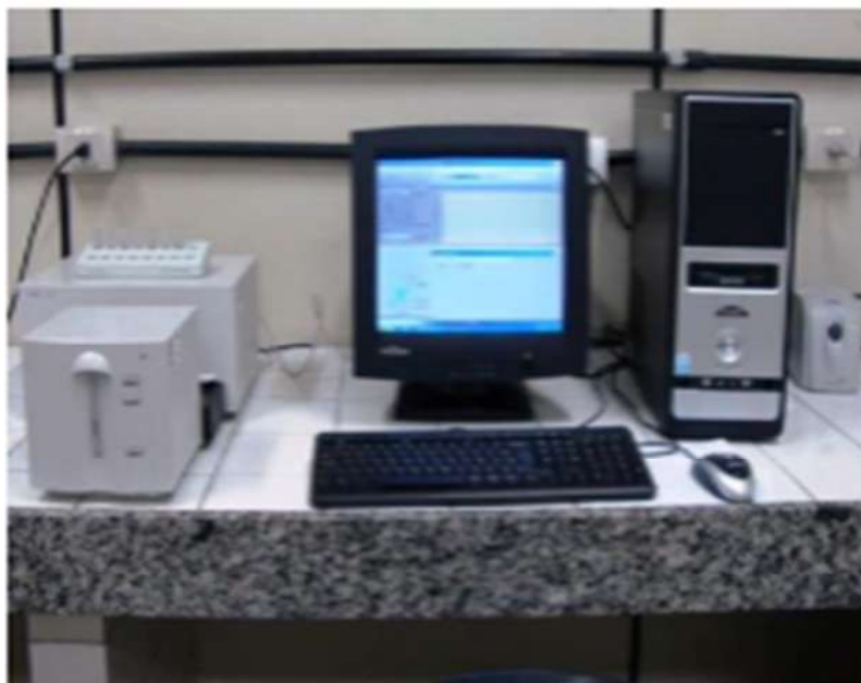
Figura 10. Aparelho de Espectofotometria utilizado para determinação da glicose plasmática, com um comprimento de onda de 505 nm.
